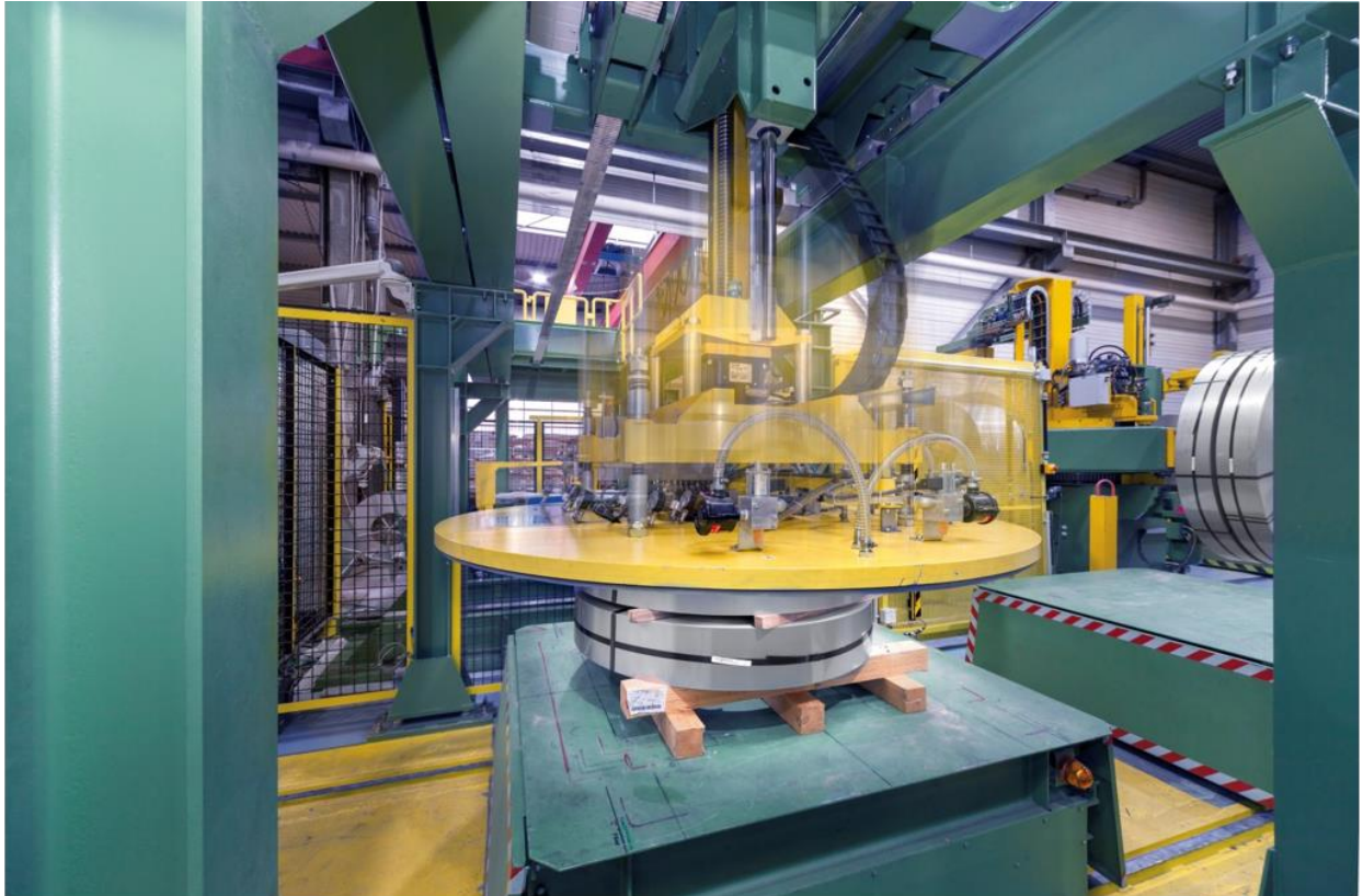
L'energia prodotta durante l'abbassamento del carico viene accumulata con un modulo KCM di KOLLMORGEN.
